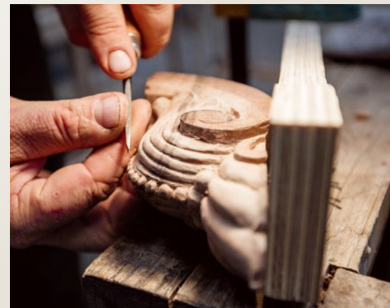
☞ A mives faelemeket az asztalosmesterek kerti diófából készítették
